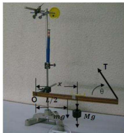
Figura 3.1: Diagrama donde se ilustran todas las fuerzas que actúan sobre el sistema
