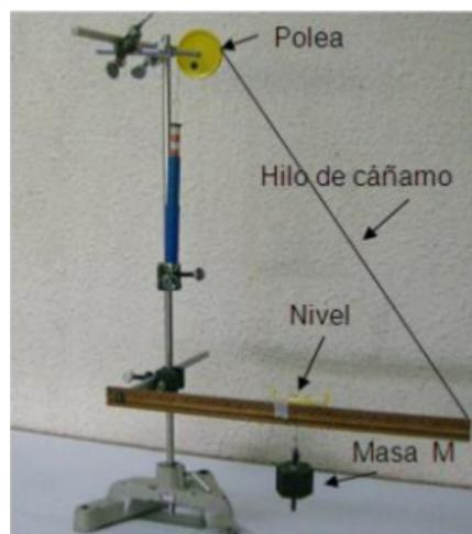
Figura 3.2: Consejo: Asegúrese que la polea se encuentra perfectamente vertical al igual que el dinamómetro, ya que de lo contrario se obtendrán medidas incorrectas.
