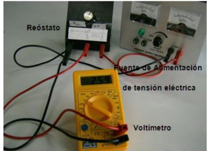
Figura 4.3: Configuración del circuito eléctrico
