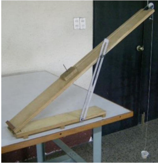
Figura 5.3: Ejemplo del Equipo Armado, asegúrese que cuando la masa m_1 se encuentre hasta arriba del plano la cuerda que sujeta a m_2 no tope en el suelo.
